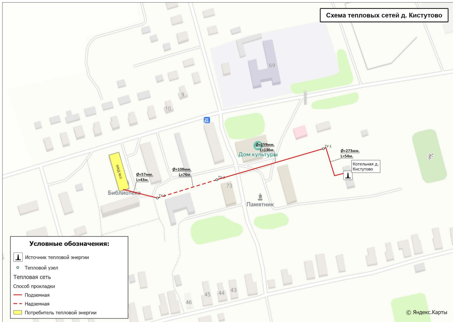
Рисунок 1.3.2.3 - Схема тепловых сетей д. Кистутово
