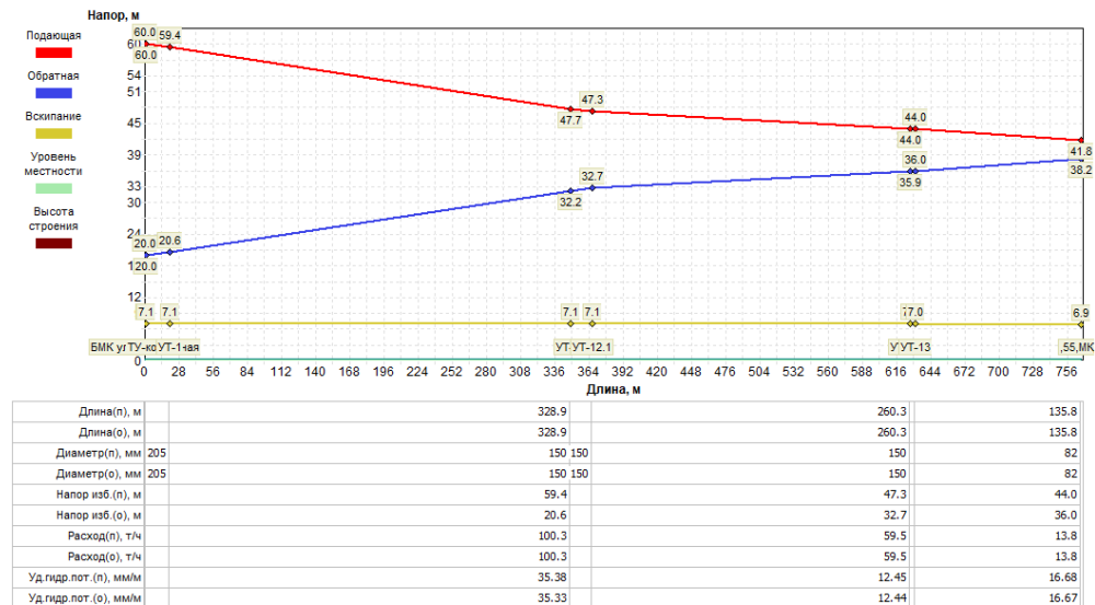
Рисунок 1.3.8.2 - Пьезометрический график участка сети «БМК ул. Спортивная -> ул. Пролетарская, 55»
