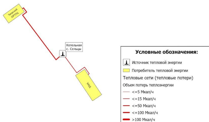
Рисунок 3.7.7 - Потери тепловой энергии при её передаче по участкам тепловых сетей с. Сельцы
