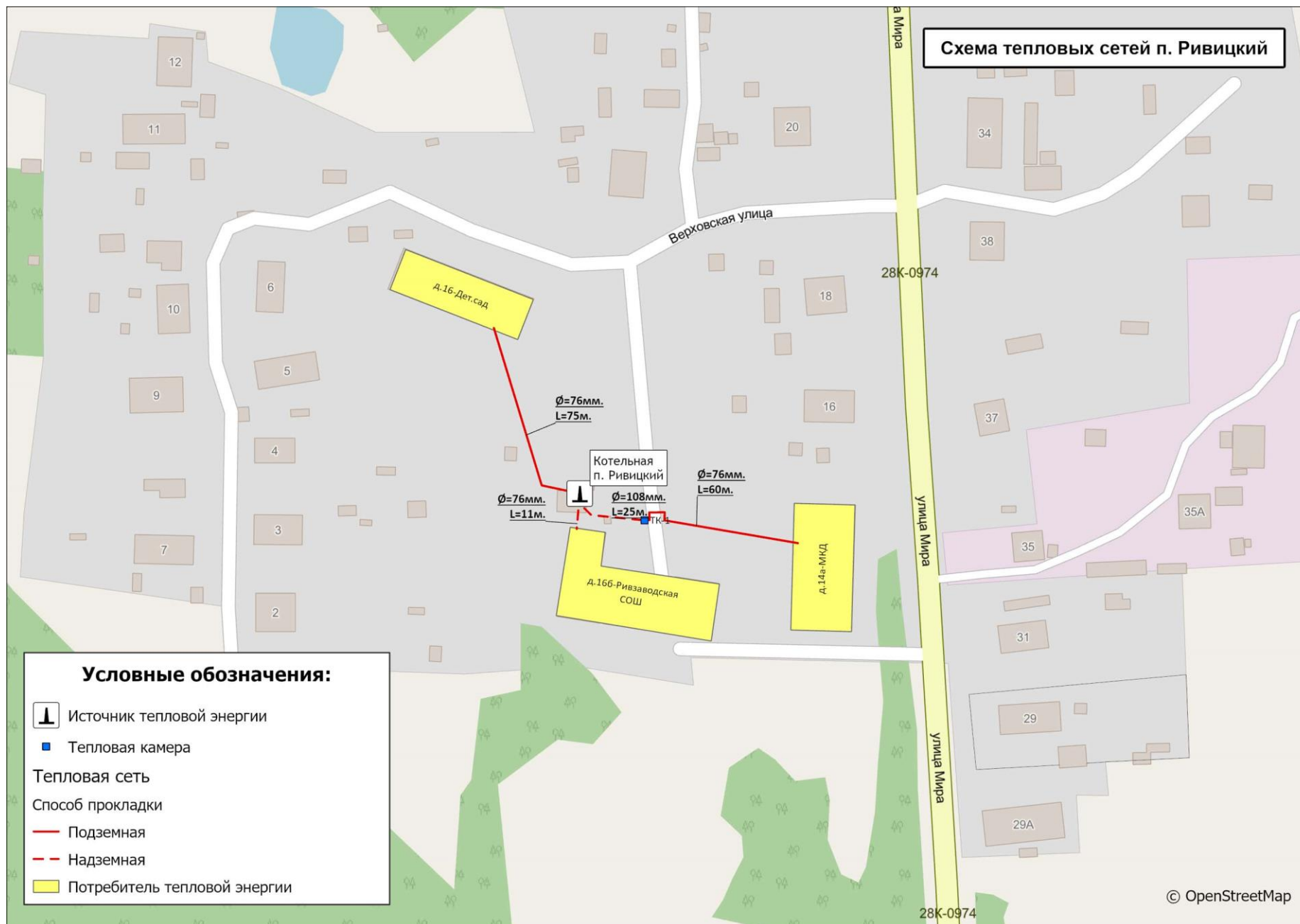
Рисунок 1.3.2.5 - Схема тепловых сетей п. Ривицкий
