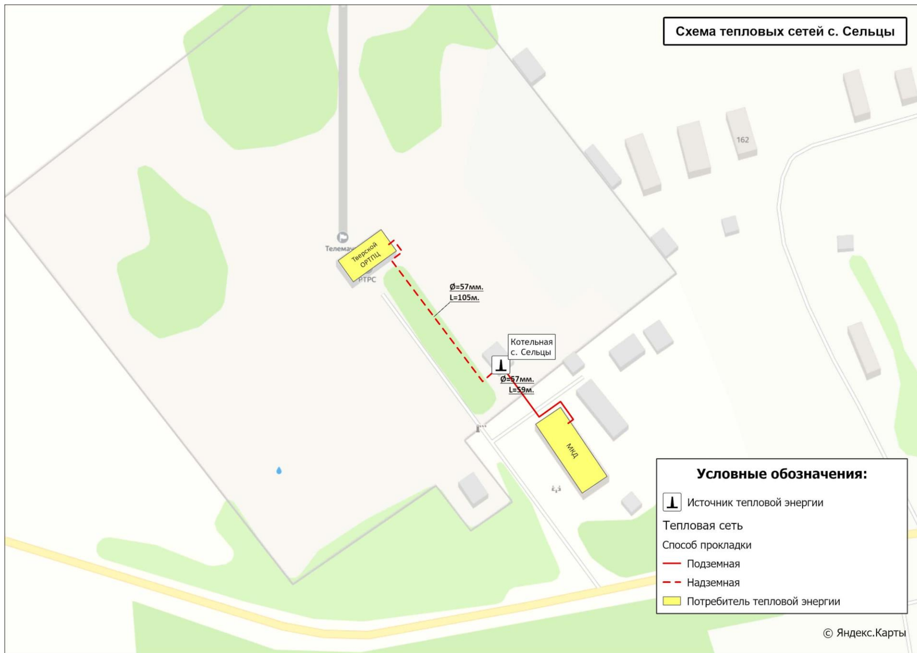
Рисунок 1.3.2.7 - Схема тепловых сетей с. Сельцы
