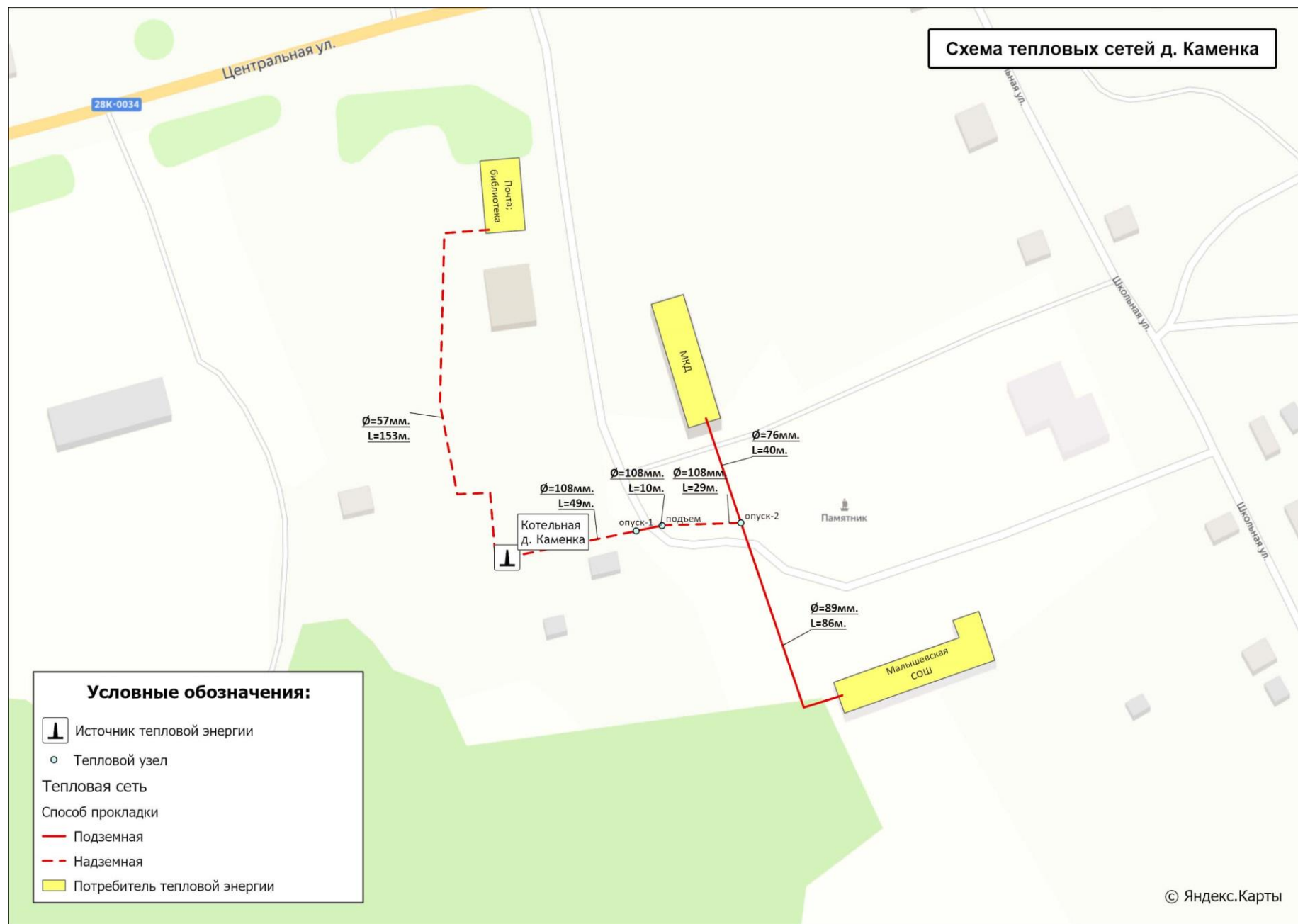
Рисунок 1.3.2.2 - Схема тепловых сетей д. Каменка
