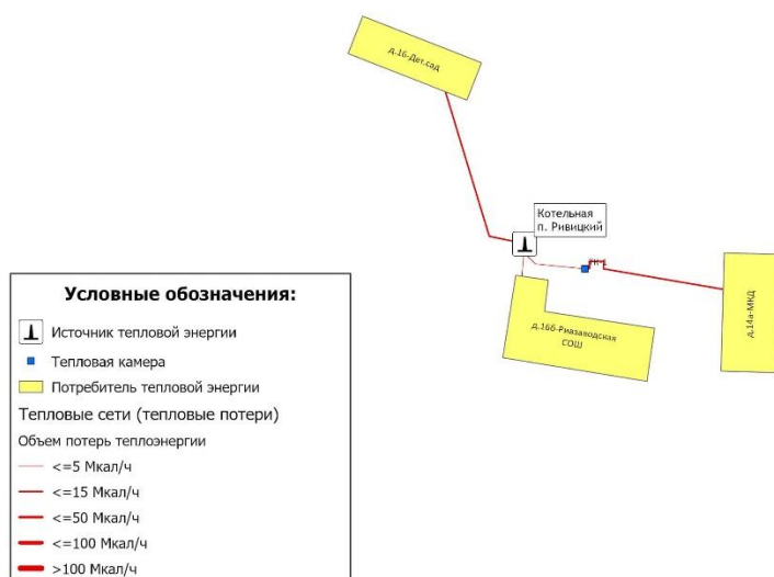
Рисунок 3.7.5 - Потери тепловой энергии при её передаче по участкам тепловых сетей п. Ривницкий
