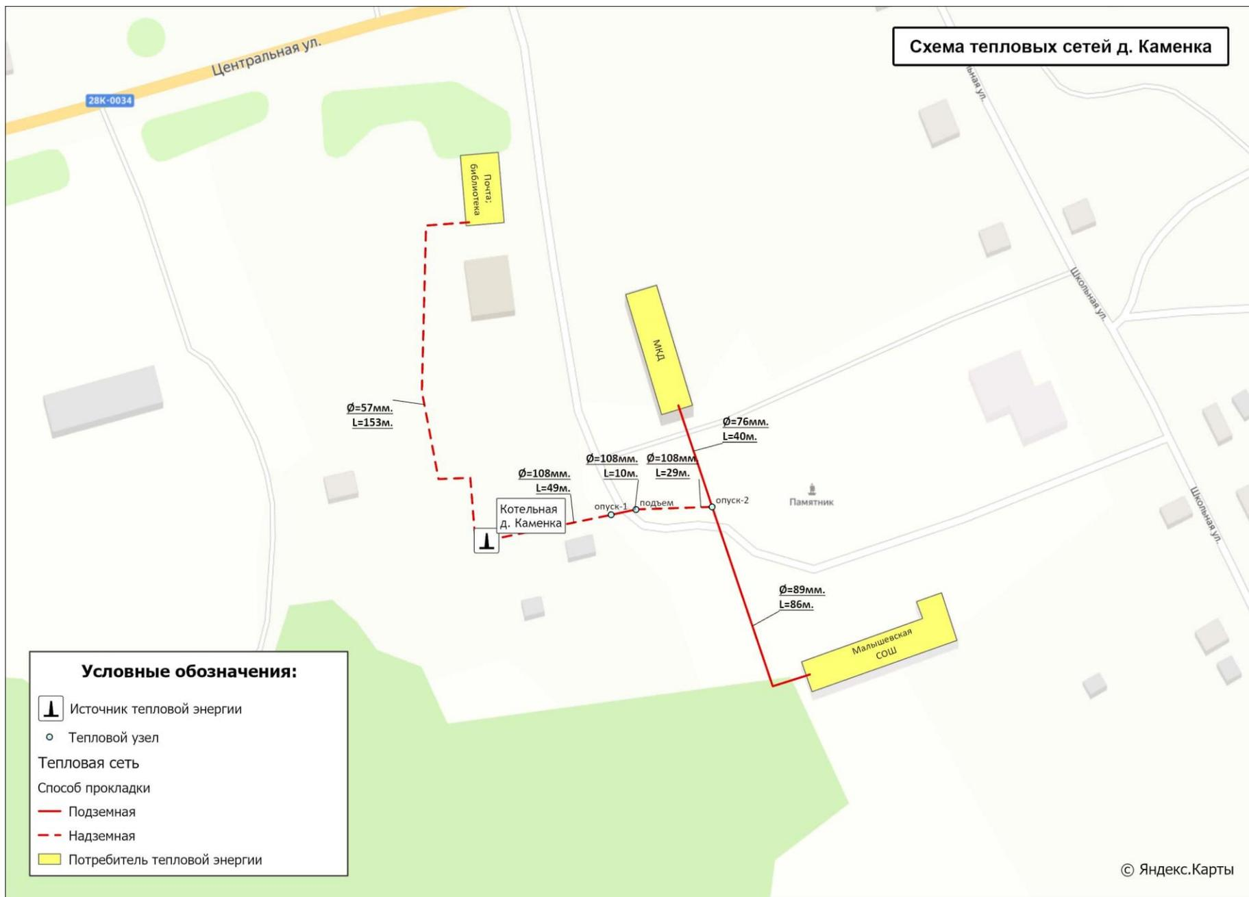
Рисунок 1.3.2.2 - Схема тепловых сетей д. Каменка
