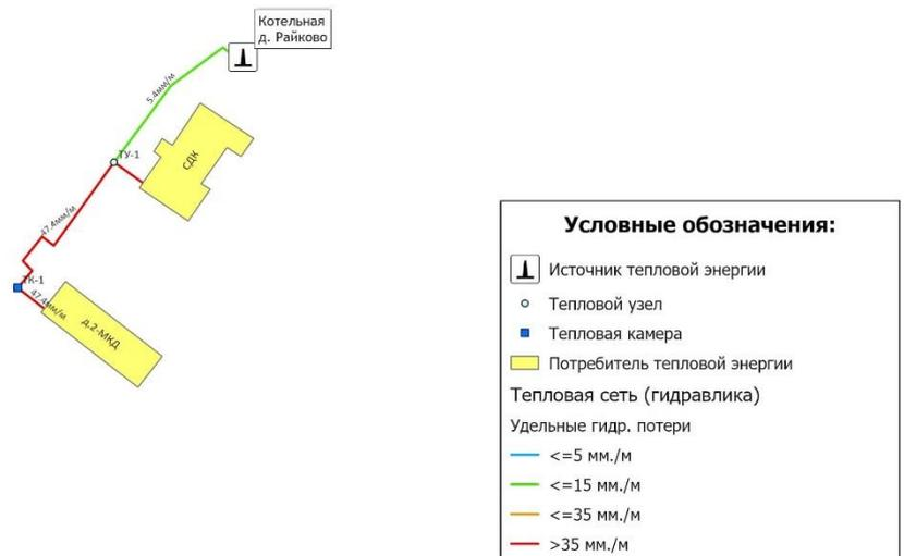
**Рисунок 3.4.4 - Удельные гидравлические потери давления в трубопроводах тепловых сетей д. Райково**
