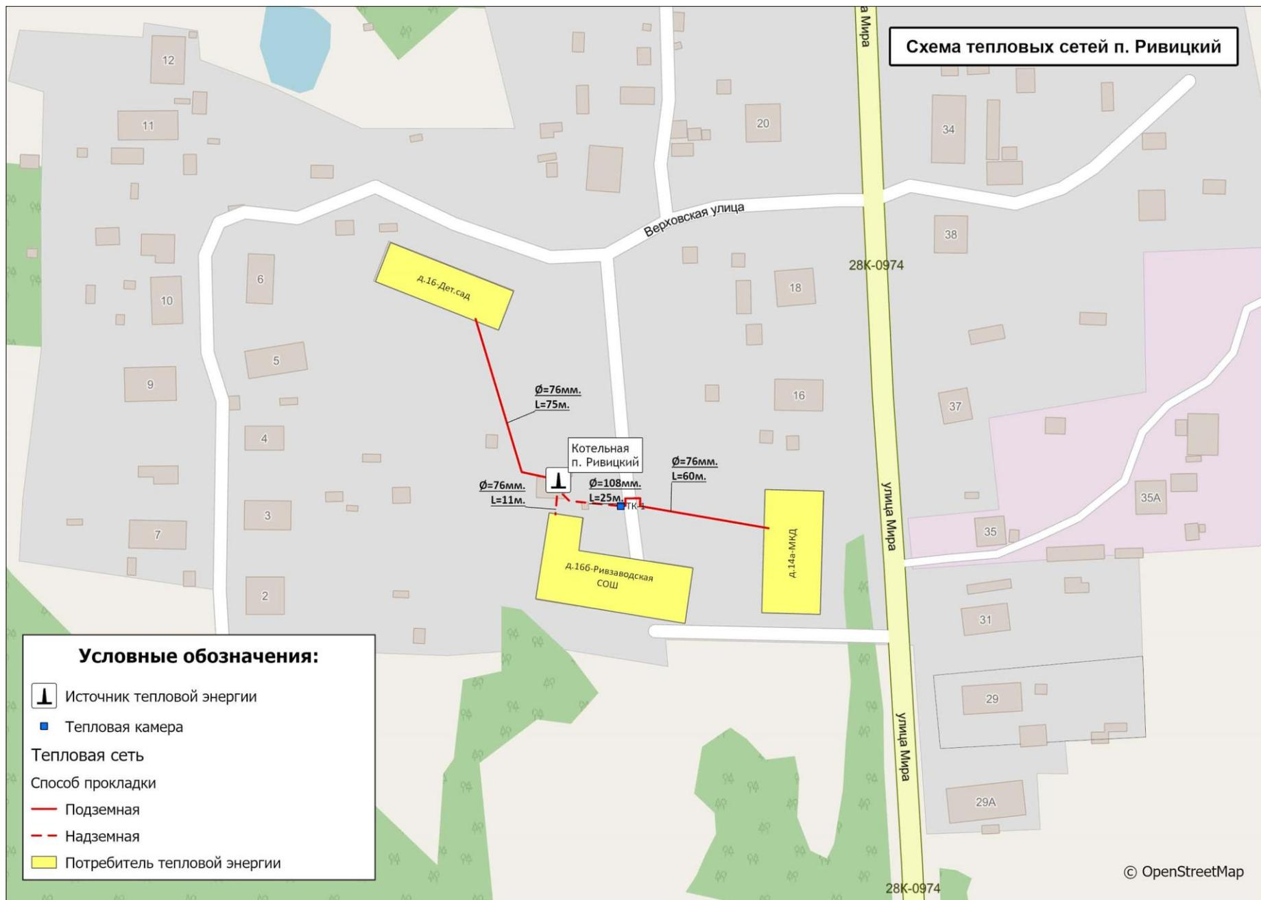
Рисунок 1.3.2.5 - Схема тепловых сетей п. Ривицкий
